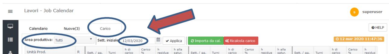
Utilizzando sia i dati delle attività pianificate che quelli relativi alle commesse al momento solo calendarizzate, JobCalendar calcola il carico di ogni singola macchina per le 4 settimane successive alla data corrente o ad una data a scelta tramite apposito calendario ("sett. Iniziale"), filtrabile eventualmente anche
